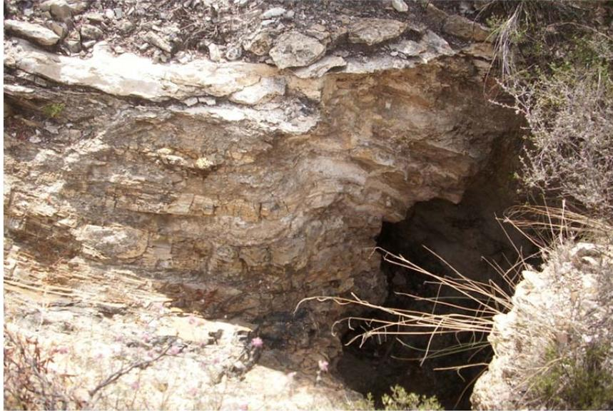
Fotografía 29. Socavón desarrollado en caliza para la explotación de Hg, en la localidad Mérida.
