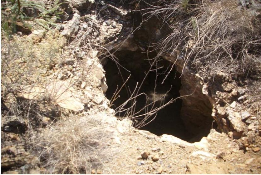
Fotografía 7. Socavón inclinado para la explotación de mercurio en la localidad.
