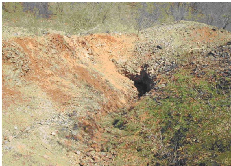
Fotografía 15. Zanja a rumbo de veta de la mina La Jaimeña
