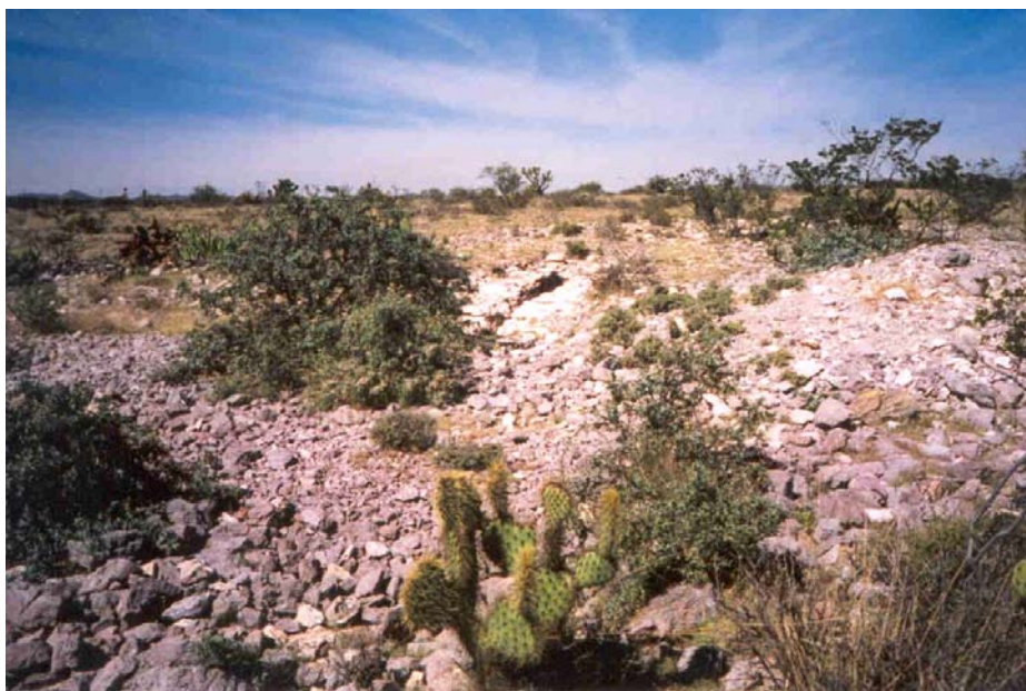
Fotografía 6. Vestigios de terreros, obra La Tinaja, donde se extrajo mineral de estaño en fracturas de una toba riolítica.
