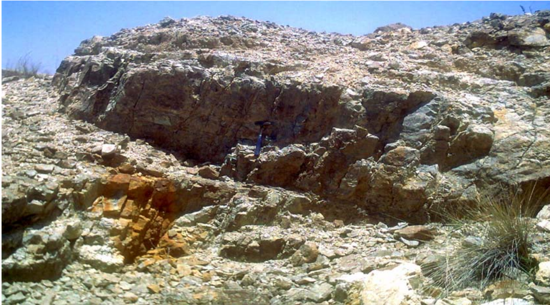
Fotografía 16. Rebaje mina Las Palomas, donde se observa dique ácido mineralizado, encajonado en roca caliza.
