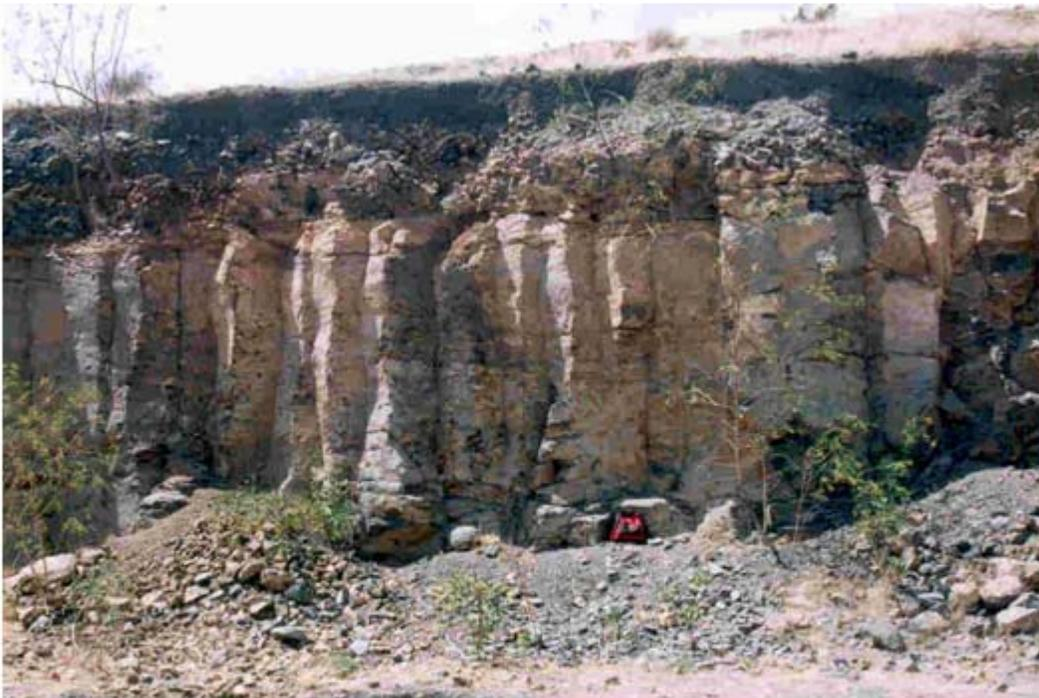
Fotografía 48. La Vía, basaltos columnares donde se extrajo grava y balastro para la vía del ferrocarril, actualmente se trabaja por temporadas.
