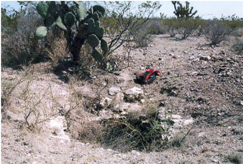
Fotografía 22 Sarabia, pozo de exploración, con el cual cortaron un lente de manganeso.
