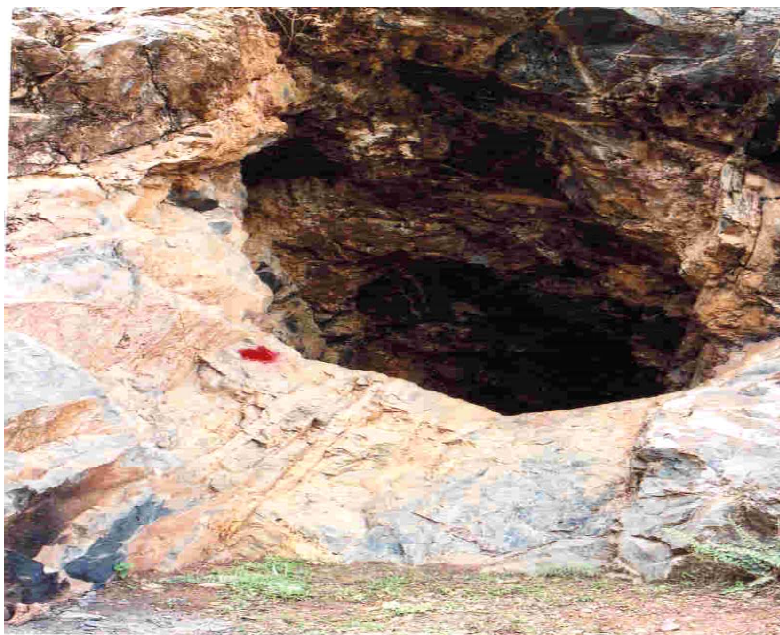
Fotografía 20. Mina El Grifo, socavón realizado en un escarpe, siguiendo vetas de cuarzo.
