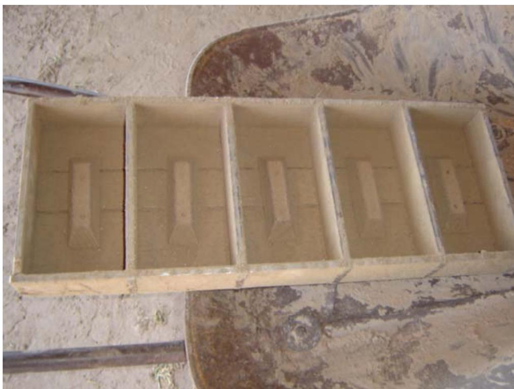
Fotografía 5: Base para moldeado de la mezcla de donde se obtiene el tabique regular en cada centro de producción, Indaparapeo, Michoacán
