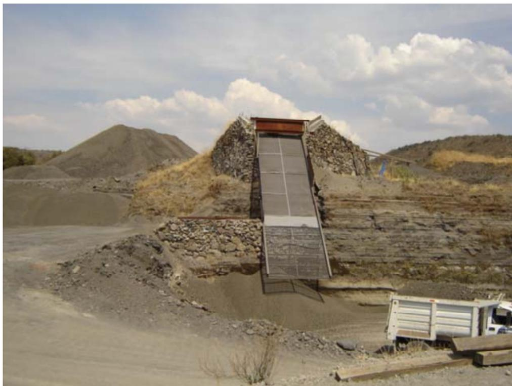
Fotografía 21: Vista de la criba de separación para obtención de sello, arena y grava en el banco Agua Salada, Indaparapeo, Michoacán
