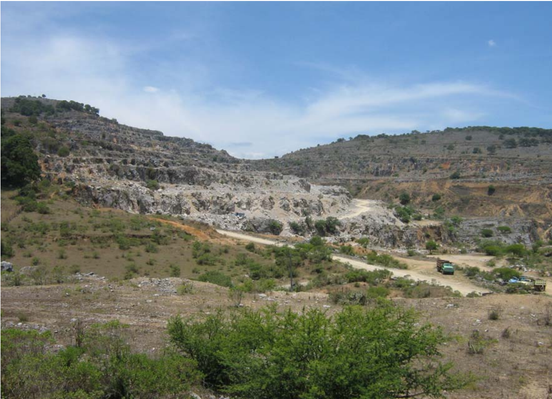
Fotografía 1. Explotación por método de banqueo de fosforita en el Tajo La Negra.
