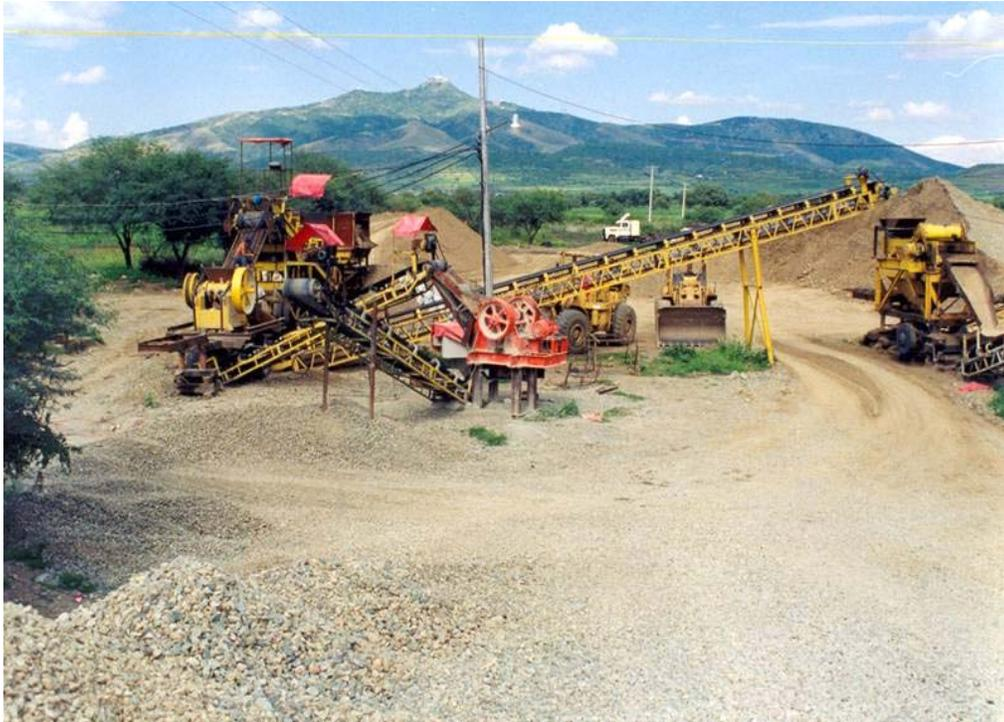
Fotografía 17. Banco La Esperanza, constituido por una andesita basáltica, con un volumen potencial de 300,000 m<sup>3</sup>, produce grava triturada.
