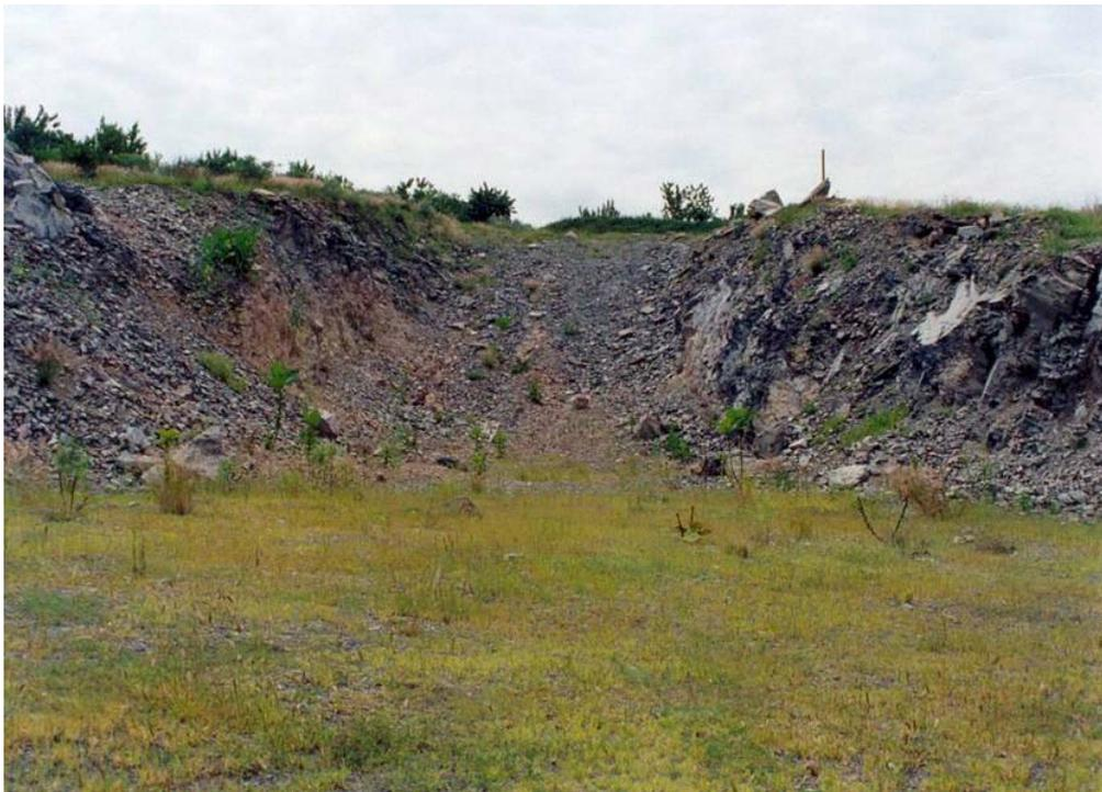
Fotografía 18. Banco El Pirúl, constituido por una andesita basáltica, que es utilizada como grava triturada, con un volumen potencial de 225,000 m<sup>3</sup>.
