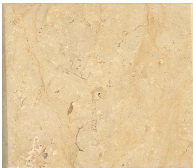
Fotografía 9. Superficie pulida de un bloque cortado de caliza de la localidad Ejido Nuevo San Pedro.
