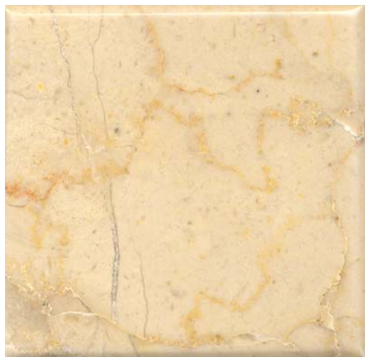
Fotografía 13. Superficie pulida de un bloque cortado de caliza de la localidad Santo Niño.
