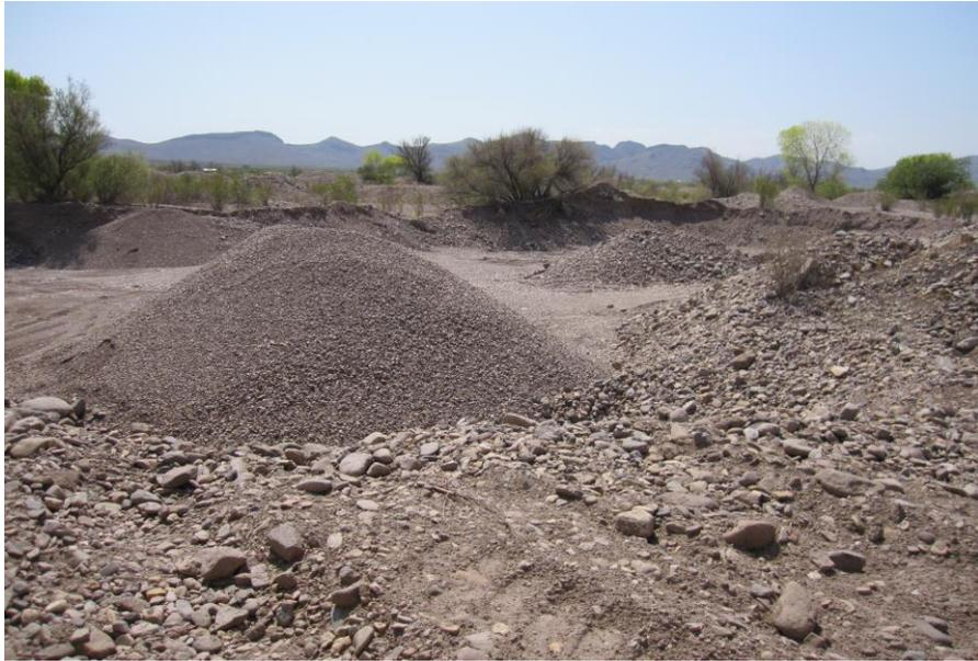
**Fotografía 49.** Extracción de arena y grava de las terrazas aluviales del río Sacramento, Mpio. Chihuahua, Chih.
