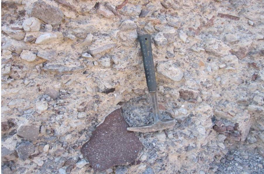
**Fotografía 57.** Granulometría del tajo de materiales pétreos de la localidad Tajo Francisco Villa, Mpio. Chihuahua, Chih. Entre los agregados que componen el depósito se tienen brechas de riolita de gran tamaño.
