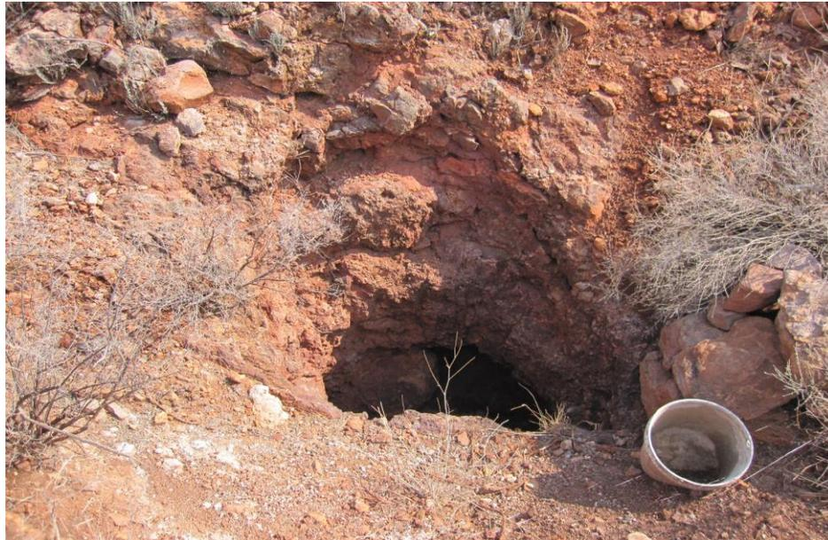
**Fotografía 9.** Pozo de extracción del filón silicificado en riolitas de la localidad El Presón, Mpio. Chihuahua, Chih.
