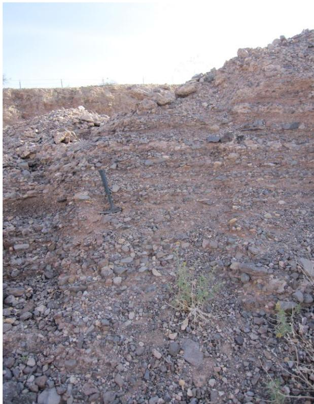
**Fotografía 67.** Distribución granulométrica natural del depósito de agregados pétreos de la localidad Colonia Ocampo, Mpio., de Chihuahua, Chih.
