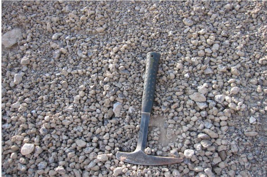
**Fotografía 55.** Granulometría del depósito de agregados pétreos de Puerto La Noria, Mpio. Chihuahua, Chih.
