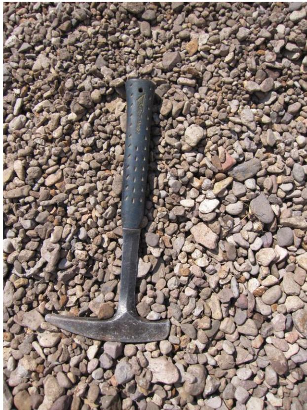
**Fotografía 50.** Granulometría del material sobrante o de desecho de la extracción de arena de la localidad Sacramento I.
