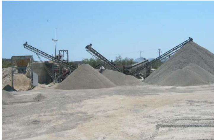
Fotografía 18. Equipo para producción de grava de 1\frac{1}{4} concreto, grava \frac{3}{4} para carpeta, grava \frac{3}{8} para sello, arena de arroyo y arena (GUSA).
