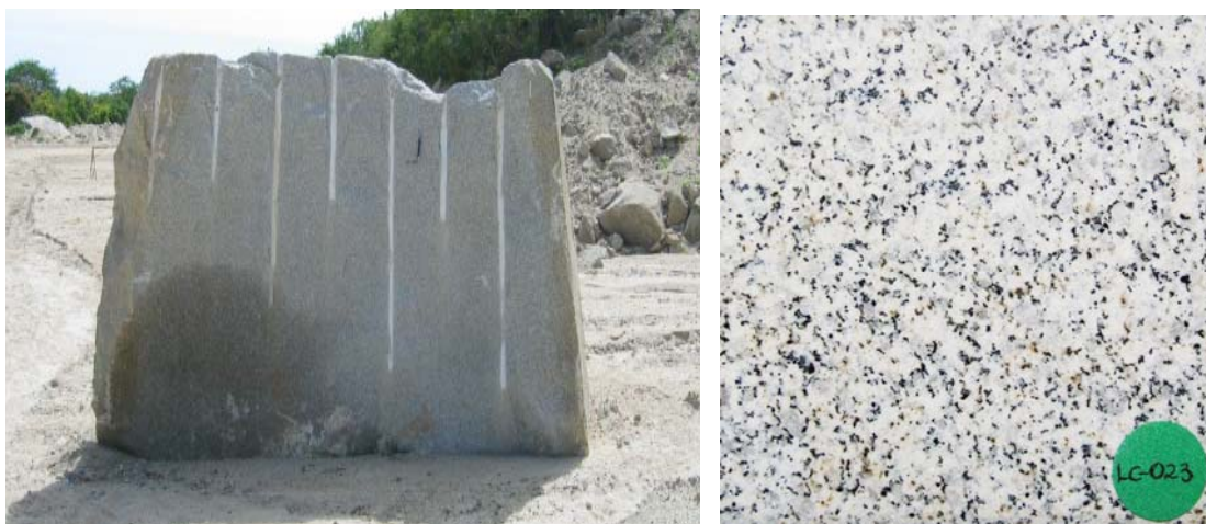
Fotografías 5 y 6. Bloque y sección pulida de granito, localidad La Pradera.
