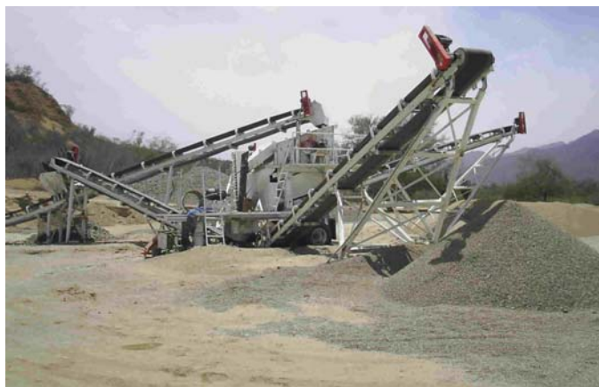
Fotografía 15. Equipo para producción de grava de 1¼ concreto, grava ¾ para carpeta, grava ¾ para sello, arena de arroyo y arena.
