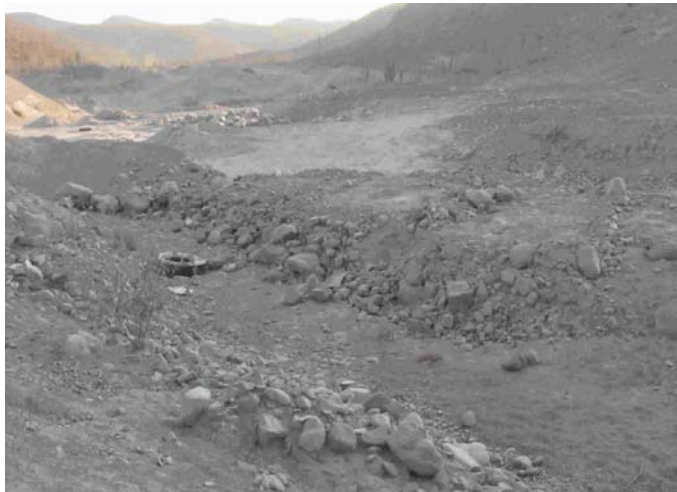
Fotografía 66. Banco de grava-arena activo con gran cantidad de rodados los cuales son triturados para producción de grava.
