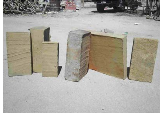
Fotografías 15 y 16. Arcilla limo-arenosa utilizada en la fabricación de tabique.
