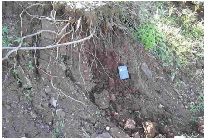
Fotografía 17. Arcilla limo-arenosa, con presencia de gravas, fabricación de ladrillos y tejas.
