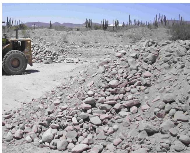
Fotografía 80. Banco activo de grava, material apilado listo para triturarse.
