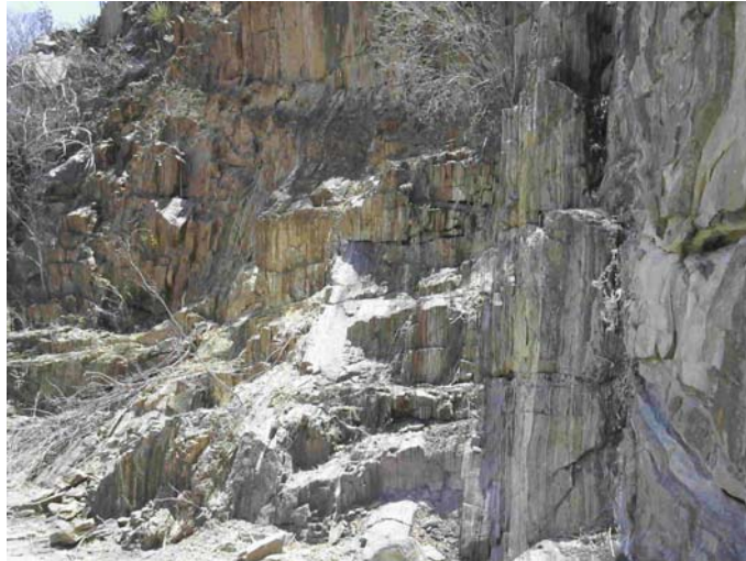
Fotografía 45. Afloramiento de esquistos en donde se observa su foliación para ser utilizada en lajas.
