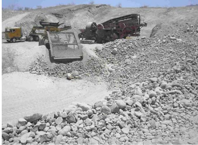
Fotografía 53. Banco activo, producción de grava, se observa equipo de trituración y criba hechiza.
