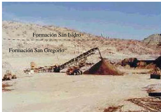
Fotografía 7. Banda transportadora de mineral del interior mina.
