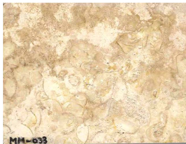
Fotografía 34.- Corte y pulido de la muestra ME-07 colectada en el banco Mulchechen, caliza con macrofósiles de la Formación Carrillo Puerto.
