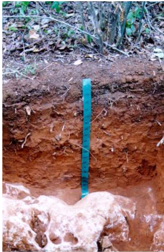
Fotografía 82.- Muestra aspecto de colección del muestreo geoquímico de suelos. Nótese la forma de recolectar el sedimento en su porción activa (horizonte B de acumulación) presenta un gran interés, ya que es ahí donde suelen concentrarse de preferencia los elementos químicos).
