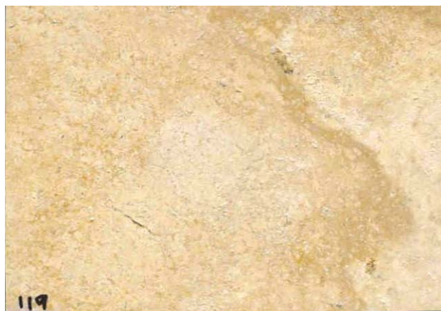
Fotografía 81.- Corte y pulido de la Muestra ME-21 colectada en el banco Ekbalam I, caliza fosilífera de la Formación Chichen-Itzá.
