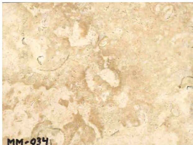
Fotografía 33.- Corte y pulido de la muestra ME-05 colectada en el banco Procom, caliza fosilífera de la Formación Carrillo Puerto.
