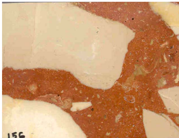
Fotografía 80.- Corte y pulido de la muestra ME-19 colectada en el banco Xcalac, brecha calcárea de la Formación Chichen-Itzá.
