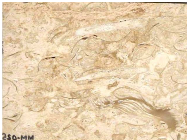
Fotografía 37.- Corte y pulido de la muestra ME-09 colectada en el banco Tricasu, caliza fosilífera de la Formación Carrillo Puerto.
