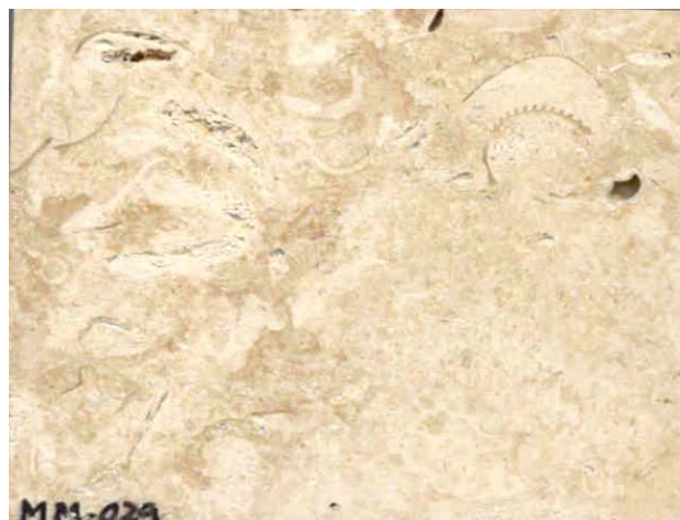
Fotografía 32.- Corte y pulido de la muestra ME-02 colectada en el banco Umán, caliza con macrofósiles de la Formación Carrillo Puerto.
