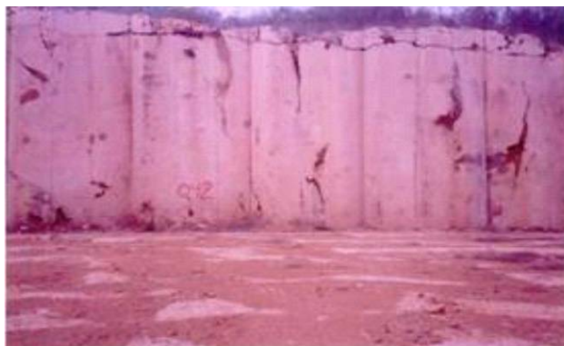
Fotografía 49.- Aspecto del banco EL Corte ubicado al sur de poblado de Calcehtock, de donde se extraían bloques con hilo diamantado.
