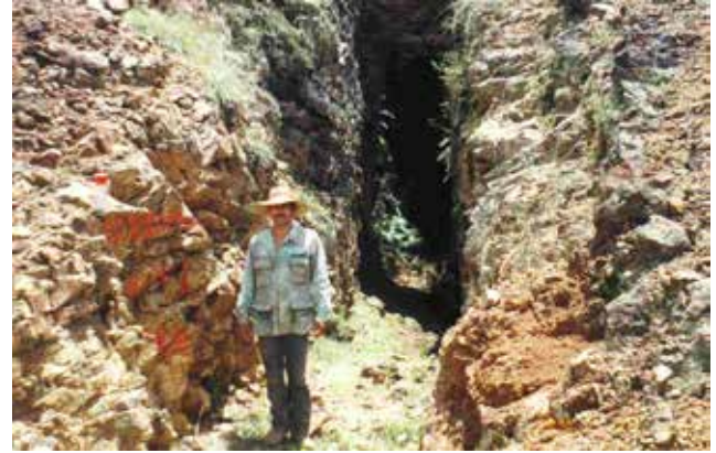
Fotografía No. 28. Vista del brocal del nivel inferior, labrado sobre skarn.
