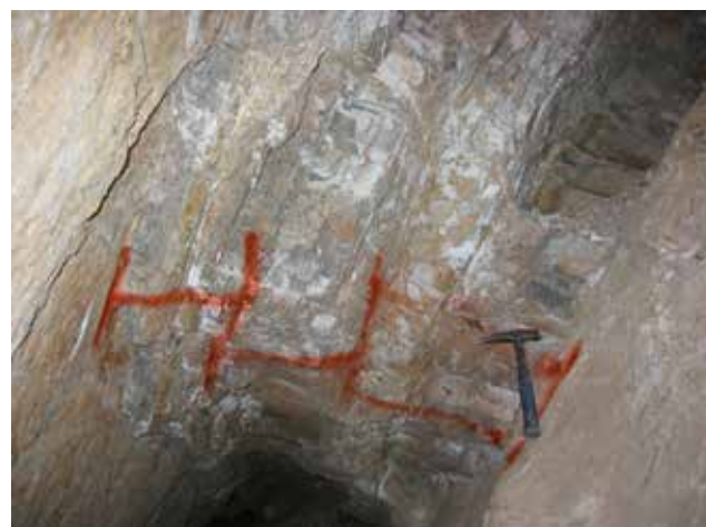
Fotografía 41.-Muestreo seccionado en la obra Chona II-1, se pueden observar la forma estratiforme de los cuerpos de fosforita
