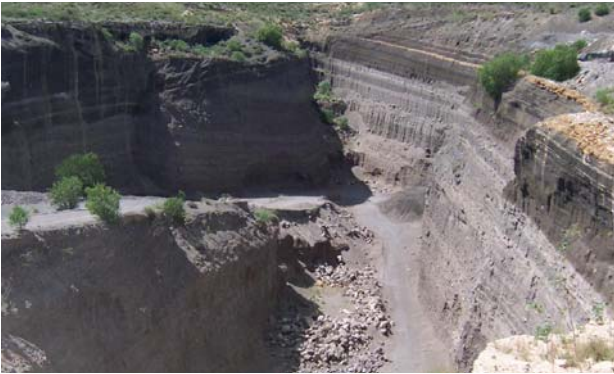
Fotografía No 42.- Tajo de gran profundidad y taludes verticales en el Banco La Providencia.
