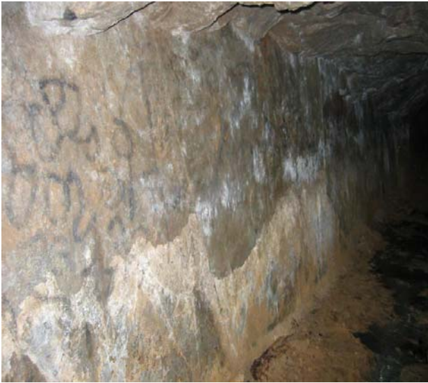
Fotografía No 11.- Plano de la falla Dios te Gué en el interior de la mina La Rica.
