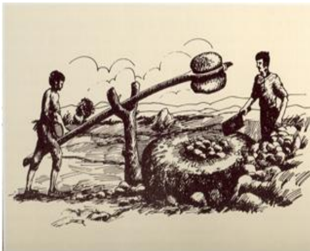
Fotografía No 12.- Representación del método antiguo utilizando en la molienda de mineral.
