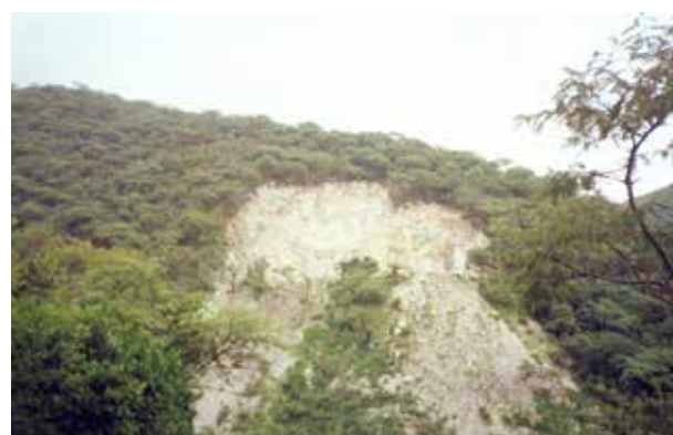
Fotografía 39. Banco Gina I, en el que se explota caliza marmolizada y recristalizada para la producción de marmolina.
