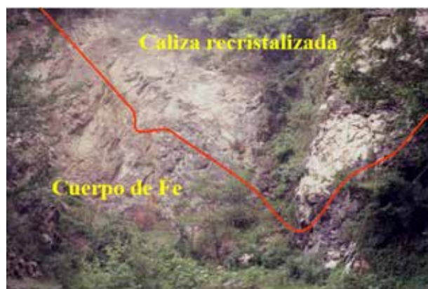
Fotografía 34. Manto de hierro, depositado en la caliza de la Formación Morelos, constituido principalmente por magnetita y hematita, bajo El Paredón.
