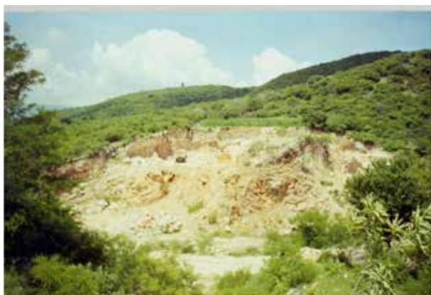
Fotografía 38. Banco La Guadalupana, donde se extrae caliza para producir agregados pétreos y marmolina, ubicada al suroriente de Iguala, la explotación es esporádica.
