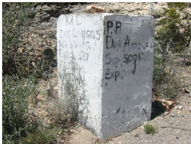
Fotografía 22.- Mojonera mostrando el punto de partida, situación legal y superficie que ampara este denuncia minero. Vista al NE.
