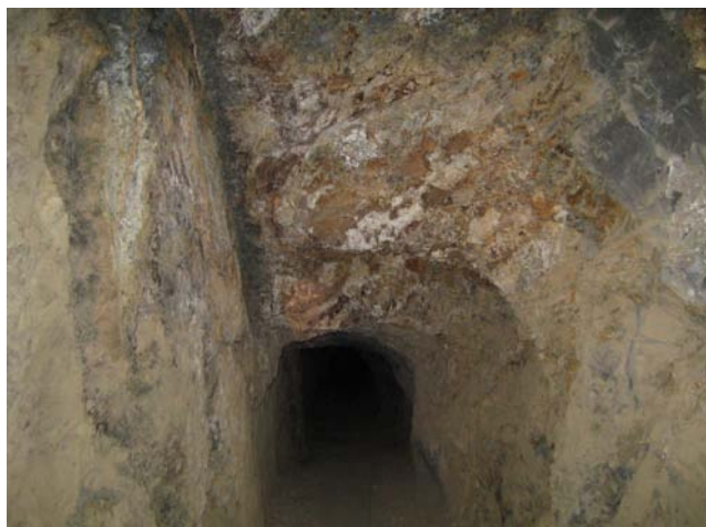
Fotografía 20.- Falla Dos Amigos, control estructural que sirvió como conducto para el emplazamiento de la mineralización en la obra minera del mismo nombre. Vista al N 20° W.
