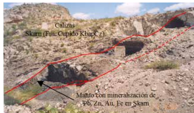
Fotografía 20.- Mina San Carlos con plomo zinc, plata, fierro y oro; la mineralización son mantos alojados en skarn y calizas de la Formación Cupido.
