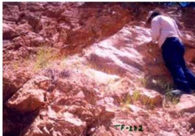
**Fotografía 10.- Granito de color rosa, con fracturamiento alto, presenta algunos planos de falla**
