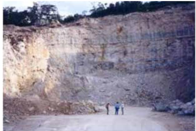
**Fotografía 82.- Banco PROTSA donde extrae grava y arena para la industria de la construcción, ubicado al suroeste de Tuxtla Gutiérrez.**
