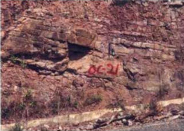
**Fotografía 53.- Arenisca de color rojizo, en estratos medianos a gruesos, muy fracturada, expuesta al noroeste de Ocosingo.**
