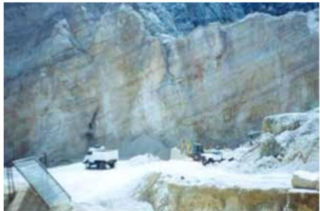
**Fotografía 86.- Caliza utilizada para producir grava y arena, utilizada por la industria de la construcción.**
