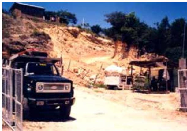
**Fotografía 79.- Banco El Sabino, labrado en caliza de la Formación Ocozocuautila-Angostura para extraer grava, localizado al noroeste de Tuxtla Gutiérrez.**
