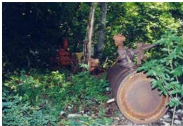
Fotografía 68.- Purificador de aire en mal estado presente en el patio de la mina La Concepción.
