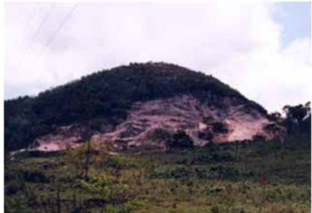
**Fotografía 78.- Banco Los Joaquines, en donde se explota caliza para obtener grava, para revestimiento de caminos.**
