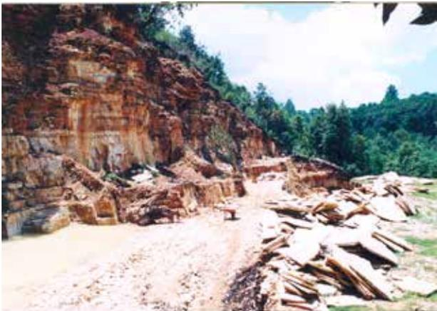
**Fotografía 85.- Caliza en estratos delgados de la Formación Sierra Madre, explotada como laja en el banco de material La Hormiga.**
