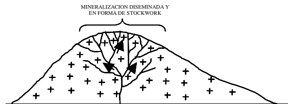
Figura 16. Sección idealizada del yacimiento de cobre tipo pórfido cuprífero de La Verde, Mich.
