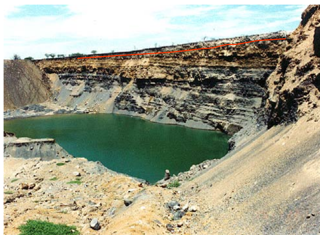
Fotografía 19 Tajío Abandonado El Refugio, Se muestra la Formación Olmos cubierta discordantemente por la Formación Sabinas.
