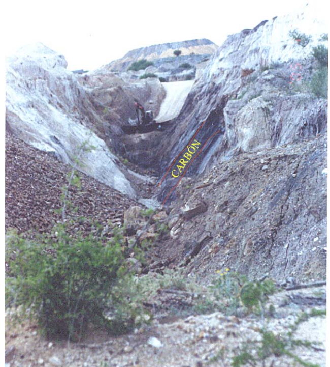
Fotografía 21 Tajo Las Esperanzas nótese el fuerte echado del manto del carbón, buzando al SW. Únicamente tienen trabajando una pala
