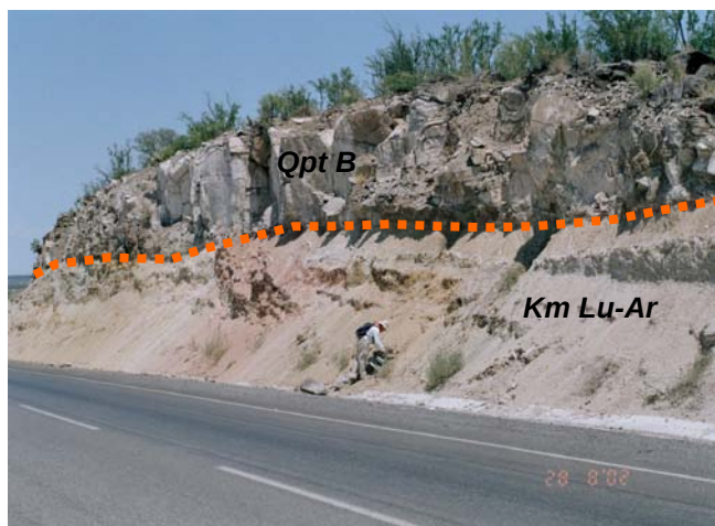
Fotografía 16 Basaltos de Meseta (Qpt B) en contacto discordante con la Formación Olmos
