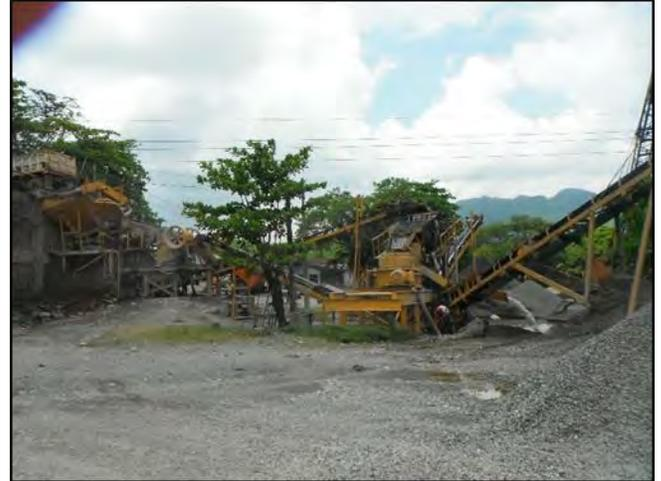
**Fotografía 60.-** Molino triturador con cribas y bandas transportadoras.
