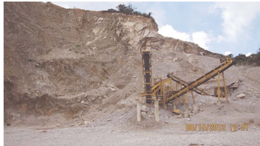
BANCO DE GRAVA Y ARENA TLAXCANTILLA (MOI-35), EQUIPADO CON QUEBRADORA, CRIBA Y TOLVA DE ALMACENAMIENTO.
