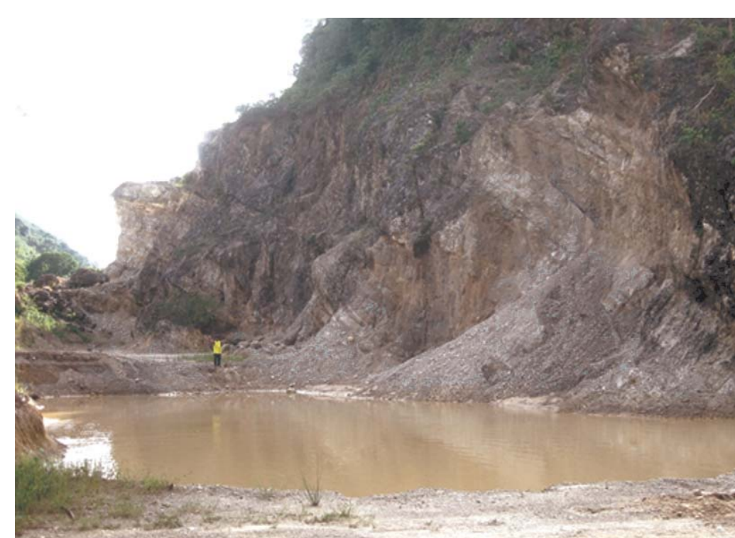
TALUD DESARROLLADO EN CALIZA ALTAMENTE FRACTURADA, DE DONDE SE EXTRAE GRAVA Y ARENA, LOCALIDAD Roca de Piedra (XO-26).
