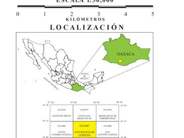
PARA TRANSFORMAR COORDENADAS DE DATUM 1929 A DATUM 1974: COORDENADAS GEOGRÁFICAS: RESTAR 127 EN LATITUD, RESTAR 87° EN LONGITUD. COORDENADAS UTM: SUMAR 36m. EN E, RESTAR 20m. EN N.
